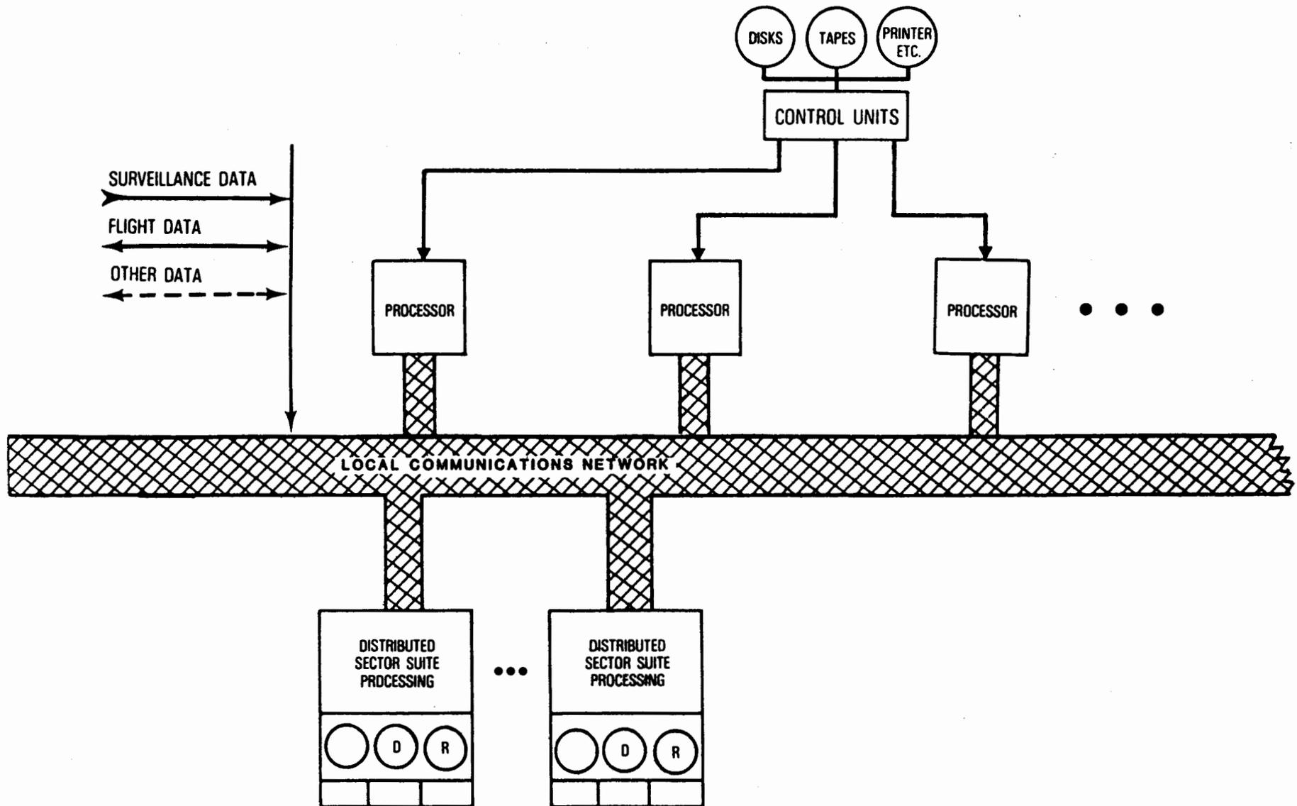
**FIGURE 9. AREA CONTROL COMPUTER COMPLEX, STATE 3**
